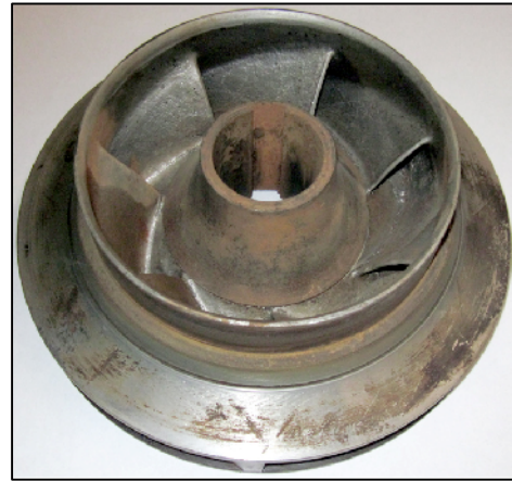
Рисунок 1 – Експериментальна установка: а) схема експериментального стенду; б) фрагмент подовжнього перерізу експериментального пристрою; в) зовнішній вигляд робочого колеса; г) зовнішній вигляд направляючого апарату; д) зовнішній вигляд передвключеного осьового колеса з негладкою статорною втулкою
