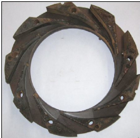
Рисунок 1 – Експериментальна установка: а) схема експериментального стенду; б) фрагмент подовжнього перерізу експериментального пристрою; в) зовнішній вигляд робочого колеса; г) зовнішній вигляд направляючого апарату; д) зовнішній вигляд передвключеного осьового колеса з негладкою статорною втулкою
