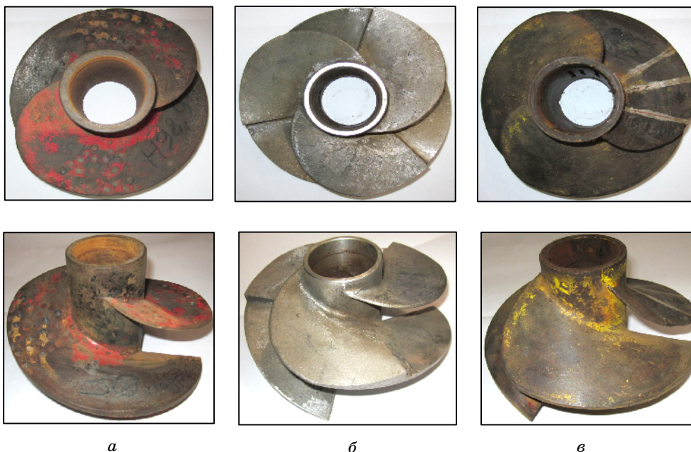
Рисунок 2 – Зовнішній вигляд досліджених передвключених осьових коліс: а - ПОК1; б - ПОК2; в - ПОК3
